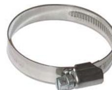
Tipo di alta qualità, in acciaio AISI 430, W1. Nastro imbutito, bordi arrotondati e rialzati. Cassetto stampato in un unico pezzo in acciaio Dacromet nero. Vite in acciaio zincato a taglio.
